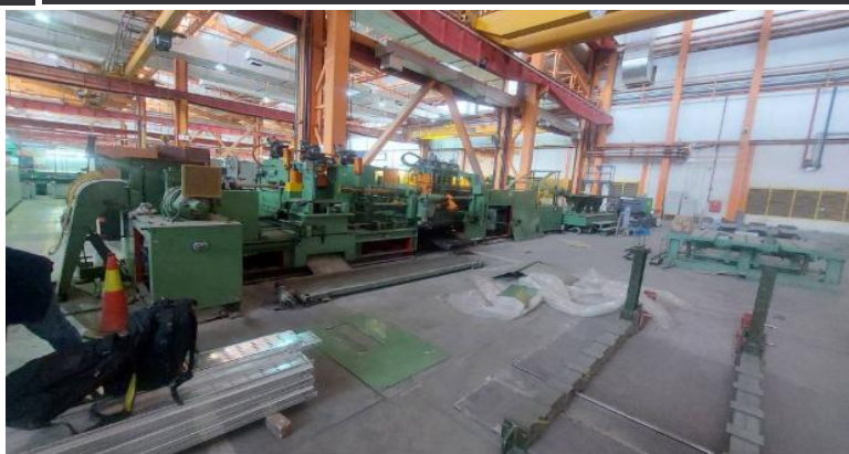
ایران ترانسفو ری (یرند - تهران) - ارتقاء کامل دستگاه برش دقیق GEORG (سال ساخت 1977) - سیستم کنترل و سروو زیمنس
